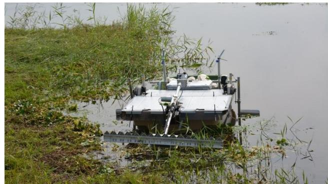
写真：ハス刈りロボットボート。両サイドのパドルで移動しながら無人かつ自動で前面のバリカンでハスを刈り払う。
